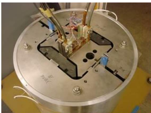
Structure mécanique réduite « Subscale Dipole »
